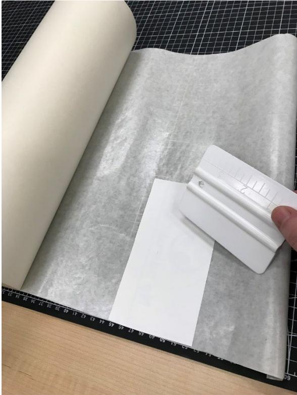
À l'aide d'une spatule, coller le vinyle sur le papier transfert en s'assurant qu'il n'y a pas de formation de bulles d'air ou de plis.
