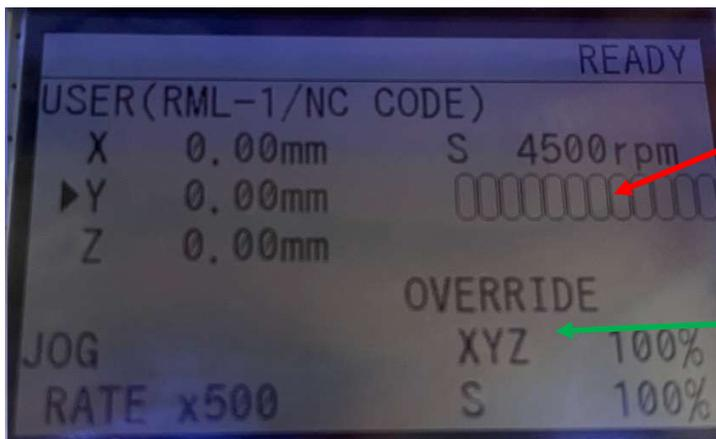
Vérifier la **barre de courant** consommé par la machine et ajuster l'« **OVER RIDE** » afin de ne pas se rendre jusqu'au bout de la barre sinon la machine stoppera immédiatement sans pouvoir reprendre là où l'on était rendu.
