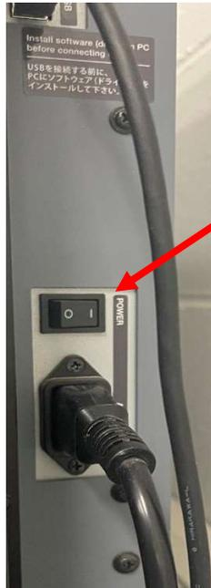
Mettre sous tension la machine à l'aide de l'interrupteur situé à l'arrière droite de la CNC.
