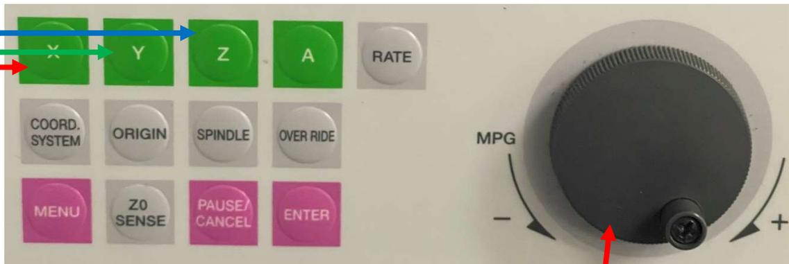
Presser sur « X » pour sélectionner cet axe. Tourner la roulette « MPG » pour la déplacer sur l'origine souhaité. (Généralement au milieu)
