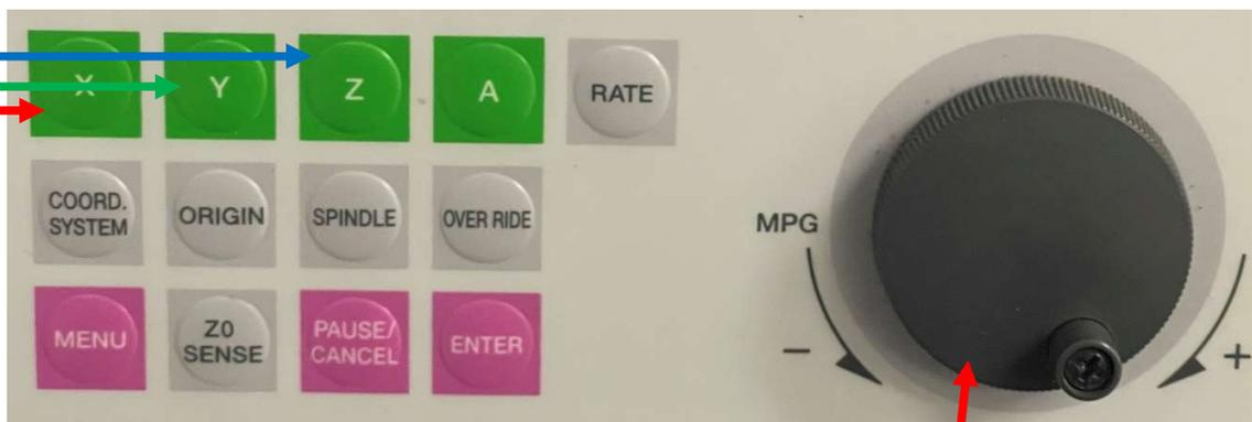
Presser sur « X » pour sélectionner cet axe. Tourner la roulette « MPG » pour la déplacer sur l'origine souhaité. (Complètement à droite de la pièce)
